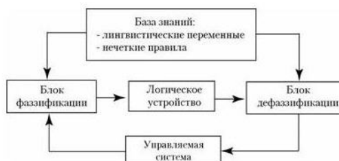
Рис. 2.26. Блок-схема микроконтроллера, реализующего нечеткую логику
